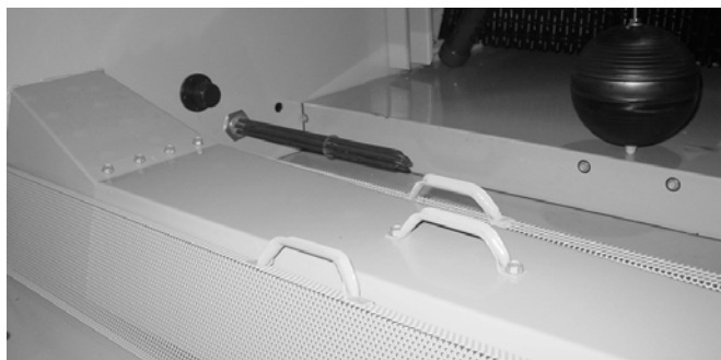
Figure 1: Bassin d'eau froide et filtre du bassin
