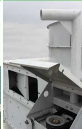
Porte d'accès coulissant vers l'intérieur Moteur avec dispositifs de réglage extérieurs et dispositif de dépose*
