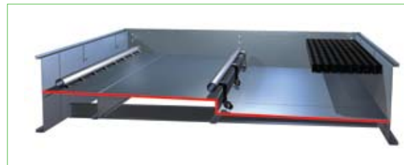
Bassin d'eau froide incliné vers la vidange, avec système d'injection de bassin* et silencieux sur le plan d'eau*
